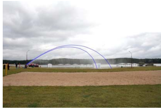
Рисунок 6 - Изображение осесимметричной струи с ограничивающими кривыми
