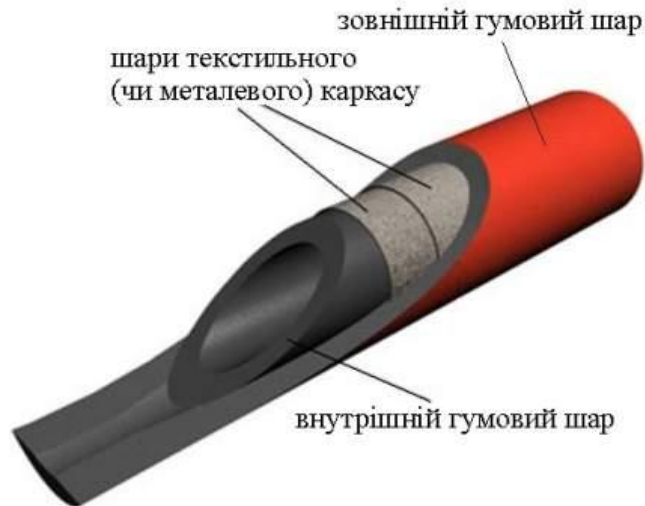
Рисунок 2 – Схематичне зображення внутрішньої будови напірних гумових шлангів
