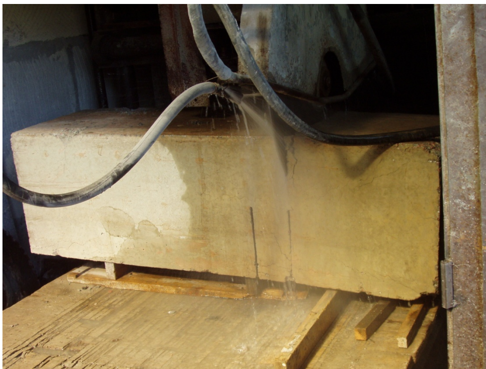
Рисунок 5. Розрізання колони алмазною пилою.
