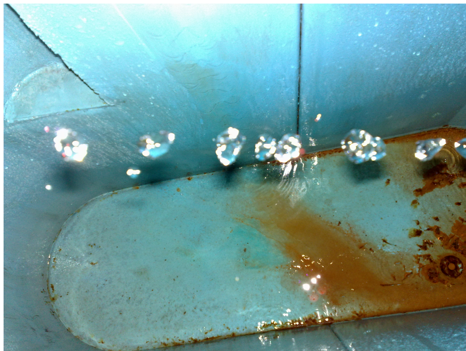
Рис.6. Форма струменю води при витіканні через циліндричний насадок з установки Маріотта ( H= 67 см).
