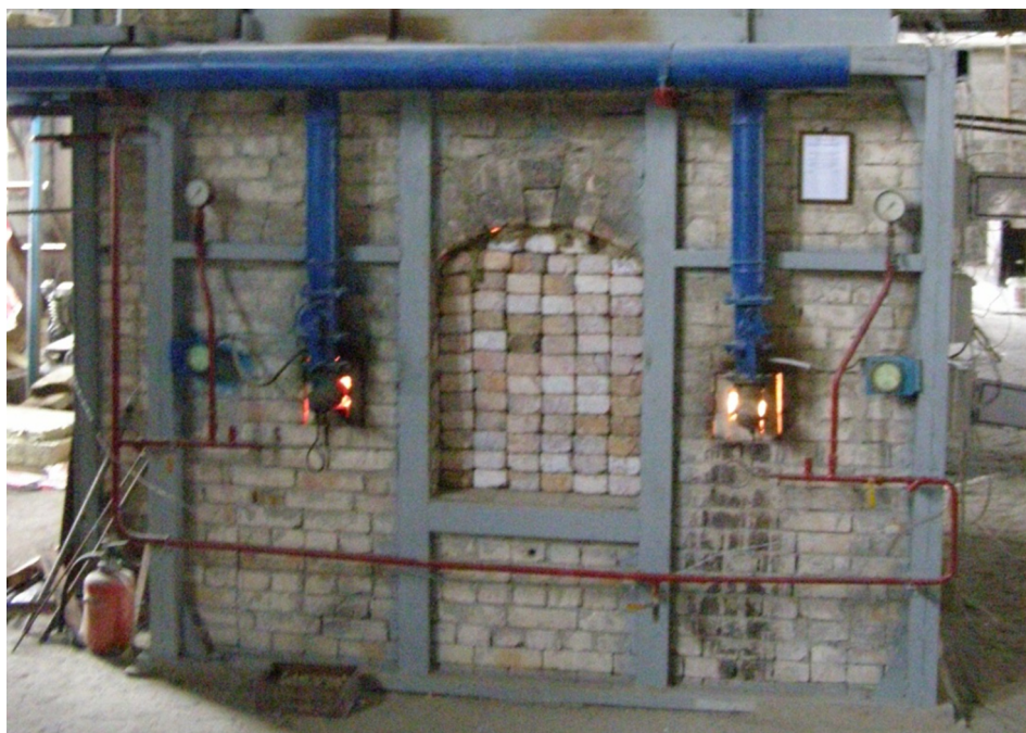
Рисунок 3. Вигляд печі під час випробування колони.
