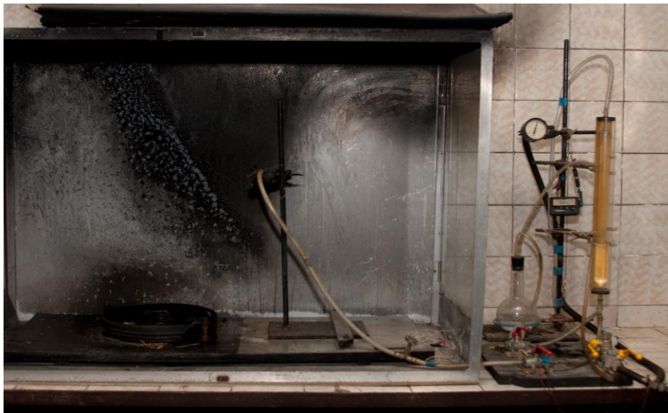
Рисунок 2 – Загальний вигляд лабораторної установки для визначення припинення горіння макетного осередку пожеж класу В.
