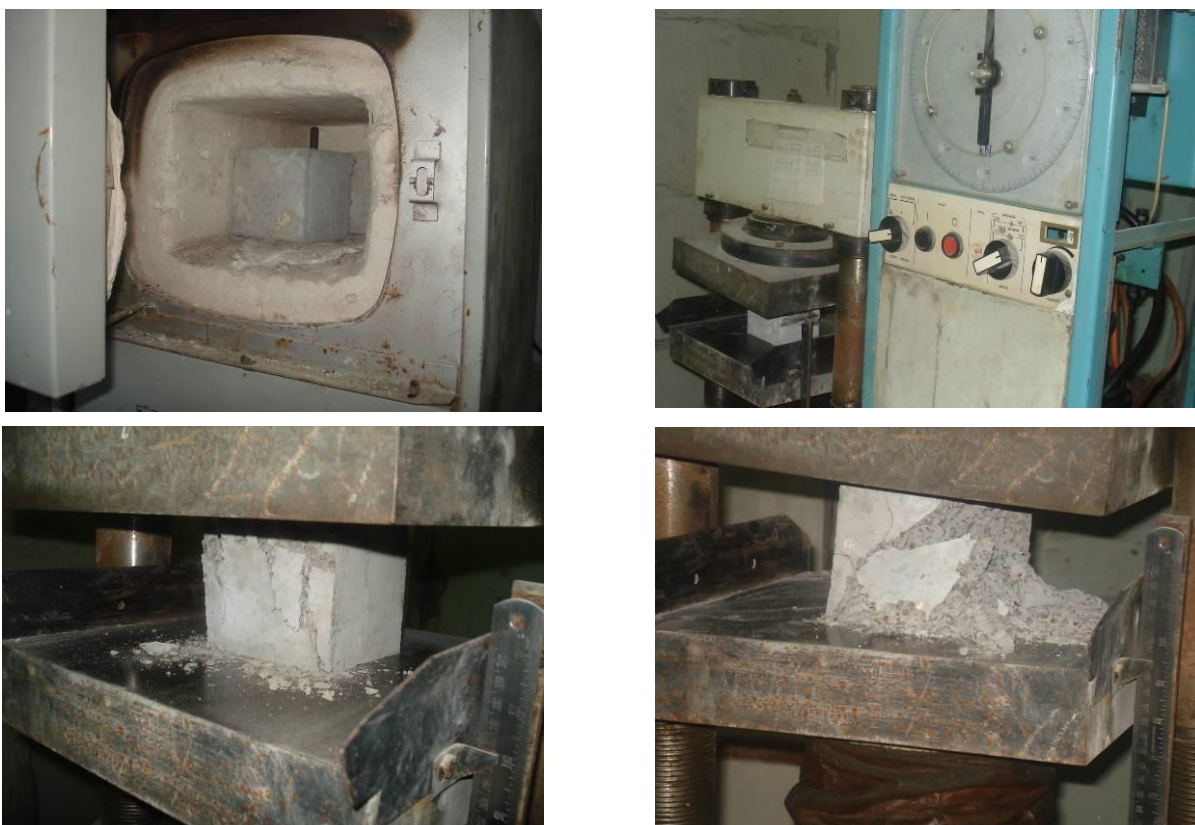
Рисунок 1 - Процесс проведения испытаний кубических образцов из модифицированного и не модифицированного бетона при их сжатии в нагретом состоянии.
