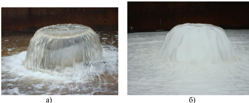
Рисунок 7 – Подача воздушно-механической пены на зеркало резервуара:
