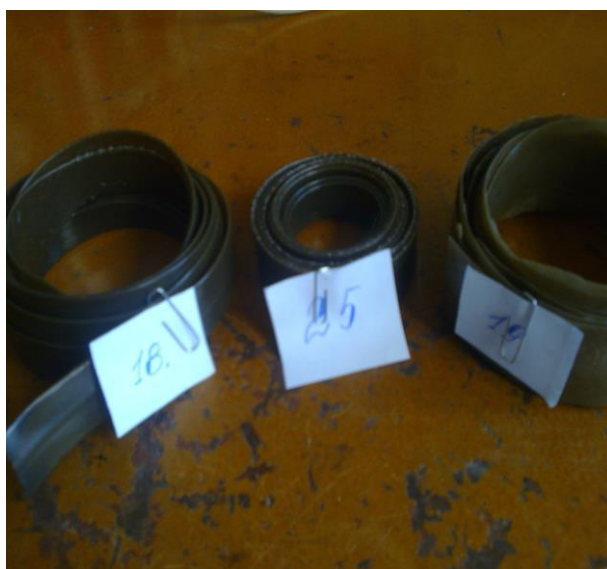
Рисунок 5 - Опытные образцы полимерной ленты с содержанием антипирена 0; 2 и 5% от массы
