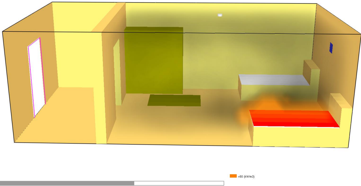
Рисунок 3 - Вид помещения с системой противопожарной защиты (76 с от начала пожара, клапан дымоудаления размером 0,25×0,25 м и продуктивностью системы 11 м 3 /с).
