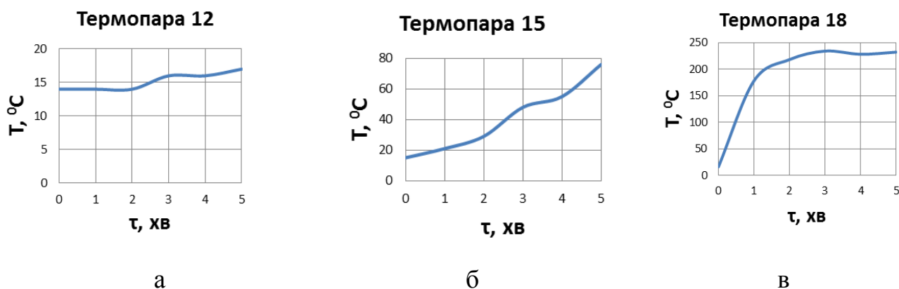
Рисунок 3 - Значення показів термопарі при пожежі в досліджуваному приміщенні:
