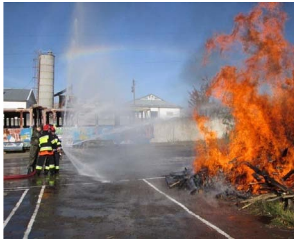
Рисунок 2 – Експериментальне визначення густини теплового потоку випромінювання від штабеля з деревиною.
