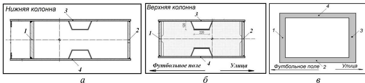
Рисунок 2 – Средние по высоте сечения нижней (а) и верхней (б) колонн и верхнего и нижнего колец (в) навеса с номерами линий (1-4), идущих перпендикулярно рисунку, вдоль которых выводились распределения температур.
