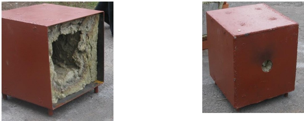
Рисунок 2 – Установка для визначення ТФХ бетону.
