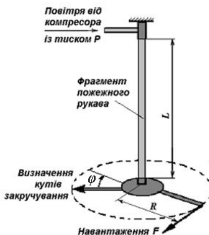
Рисунок 1 – Дослідна установка із встановленим фрагментом пожежного рукава
